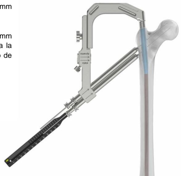
La longitud de perforación en la broca de ajuste canulado de 6,5 / 2,5 mm (1459-051) se ajusta a la longitud medida previamente utilizando un dispositivo de medición. La broca canulada se fija al mango en T de acoplamiento rápido (1459-003) y se guía a través de la vaina exterior (1459-037) para perforar el hueso. El tope en el taladro bir evita que taladre más allá de la longitud establecida deseada
