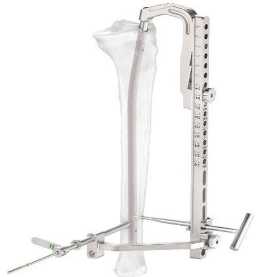
Inserte el medidor de tornillo (520-041) a través del manguito de protección y anote la longitud requerida del perno de bloqueo de Ø4,4 mm según la marca en el medidor de medición.
