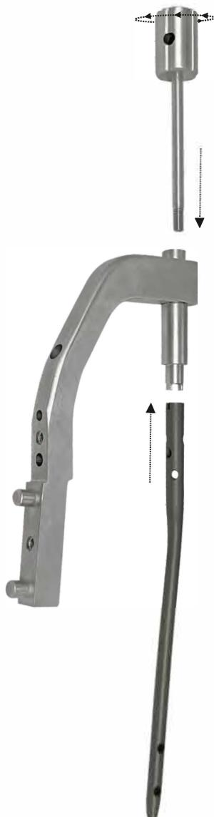
**Conjunto de clavo y plantilla:** Alinee las lengüetas del mango de inserción (INS-1296-12) con las ranuras del clavo. Inserte el perno de sujeción de clavos (INS-1296-13) a través del arco de inserción. Fije el clavo al arco de inserción apretando el perno de sujeción del clavo con la llave Allen (INS-1296-20).
